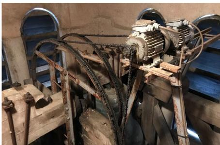
La mise en volée des cloches est assurée par 2 moteurs triphasés, 2 servo-commutateurs et 2 cercles d'entraînement. Les tintements sont assurés par un moteur par cloche afin d'assurer le glas et le carillon. Un « combinateur » permet de sonner le glas romain par la volée de la grosse cloche et le tintement cadencé de la petite. L'Angélus commandé par l'horloge peut être réglé au choix matin, midi et soir.
